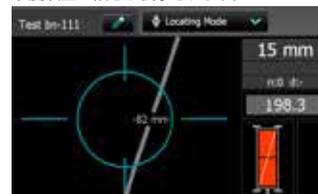
中心線⑬が鉄筋を過ぎると(プローブ中心の赤いLEDが点灯)表示されます。
