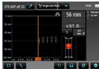
鉄筋が赤く表示される場合、鉄筋のかぶり厚さが不十分です。それ以外のかぶり厚さは十分です。
