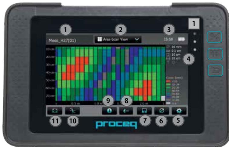
1 押すと電源が入り、もう一度押して画面の「X Off」をタップすると電源が切れます。
