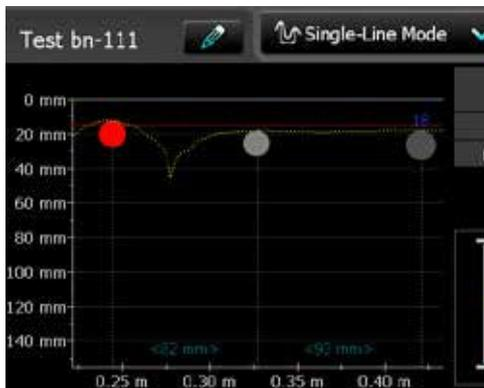
鉄筋と鉄筋の間隔 (青表示)
