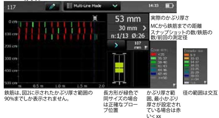
鉄筋は、図2に示されたかぶり厚さ範囲の90%までしか表示されません。長方形が緑色で同サイズの場合は正確なプローブ位置。かぶり厚さ範囲、最小かぶり厚さが設定されている場合は赤い < xx
